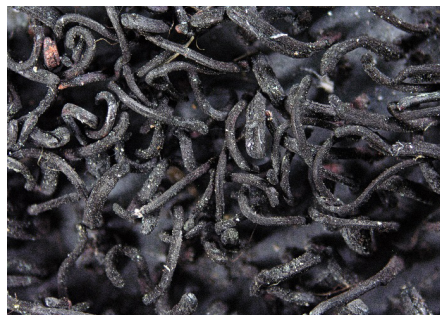
Fig. 27 Filamentos de cobre nativo sobre mata de cobre de fundición. Minas de Mankayan, Benguet, La Cordillera (CAR), Luzón. FOV 10 mm. Foto CMS.
