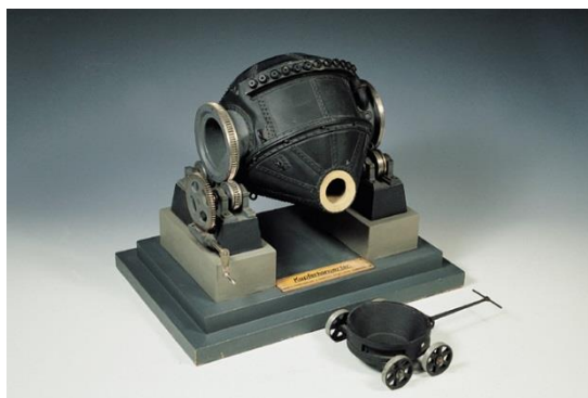
Maqueta metalúrgica de un convertidor “Parrot” para cobre
